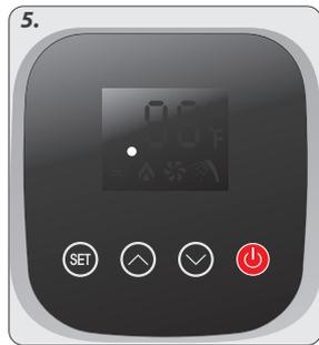
5. Após utilizar o aquecedor e fechar o registro de água quente, depois de 1 minuto inativo, o aparelho entra em *stand-by*, ficando pronto para o próximo uso, bastando apenas abrir novamente o registro para que entre em funcionamento, com a mesma temperatura que foi utilizada na última vez.
